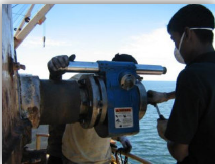
In-Situ Crane Heel Pin Repair
